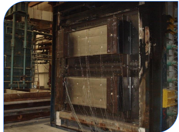
Horno de Prueba de Fuego de Hidrocarburos Laboratorio BRE Global Reino Unido
